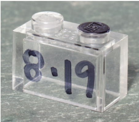
El ladrillo de 1x2 sin barra inferior antes del baño de lejía. La escritura en el lateral es de una pasada, la tinta en la barra es de varias pasadas.
