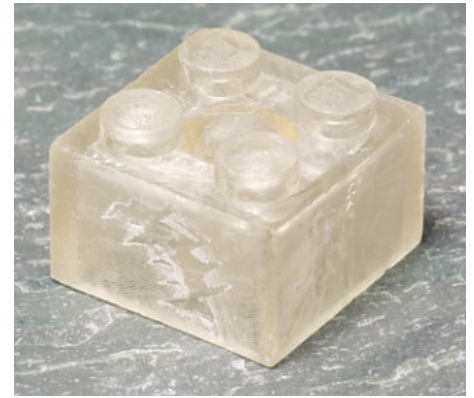
48 horas: El negro ha desaparecido por completo. La transparencia ha dado paso a la translucidez. El plástico se ha reblandecido tanto que puede despegarse con una uña.
