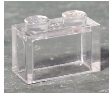
48 horas: El negro de los laterales ha desaparecido por completo, queda un poco alrededor de los bordes del logotipo en el stud. El plástico permanece transparente.
