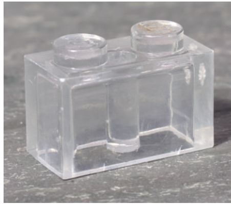
24 horas: El negro de los laterales ha desaparecido por completo, queda un poco alrededor de los bordes del logotipo en el stud. El plástico permanece transparente.
