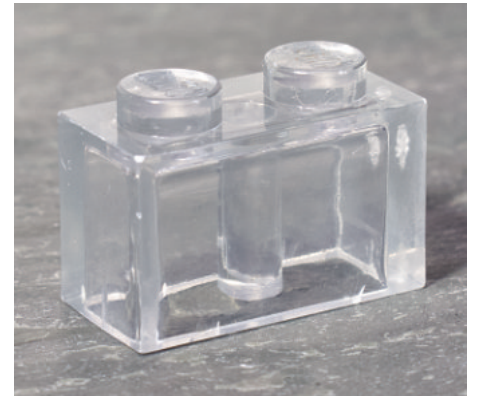
48 horas: El negro ha desaparecido por completo. El plástico permanece transparente y duro.
