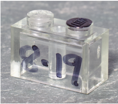
El ladrillo de 1x2 con barra inferior antes del baño de lejía. La escritura en el lateral es de una pasada, la tinta en la barra es de varias pasadas.
