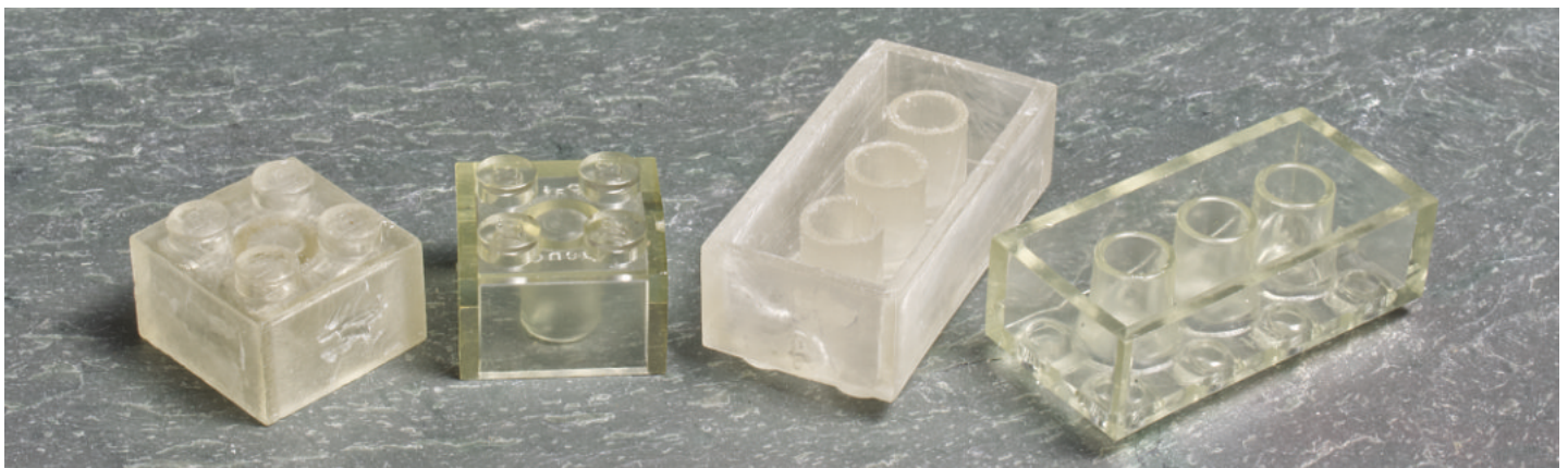
Comparación de ladrillos Pat. Pend. con y sin lejía.
