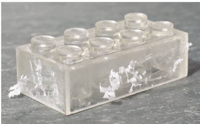
48 horas: Las marcas de Sharpie han desaparecido por completo y, al igual que con el ladrillo de 2x2, los lados se han enturbiado y se pueden rayar fácilmente con una uña.
